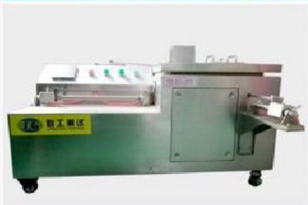
冲击试样低温仪 (-101°C冲击试验) Low Temperature Chamber(-101° C Impact Test)
